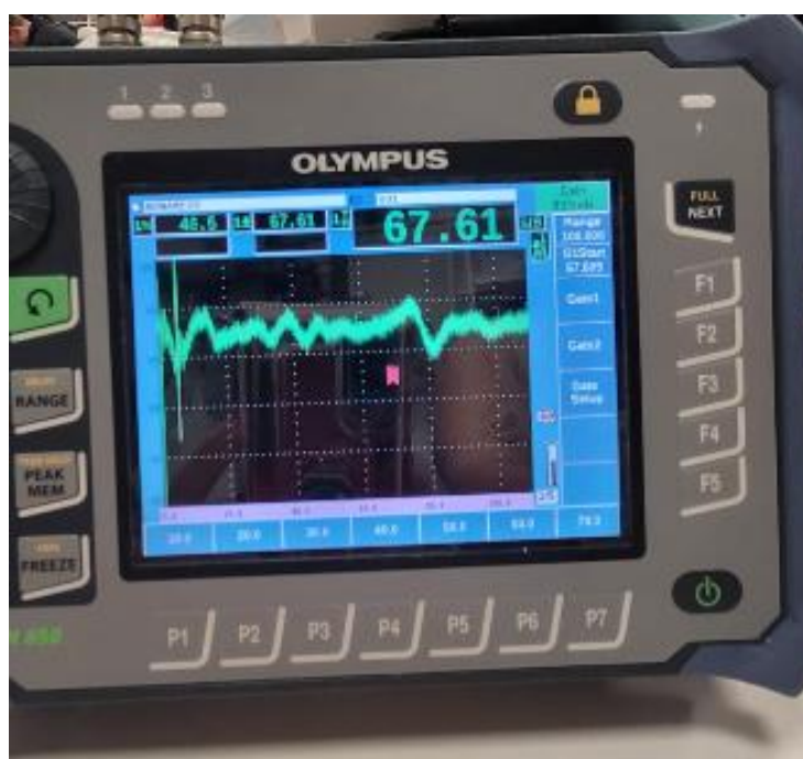
Ilustración 10. Representación de la señal captada entre el poliestireno.
